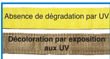
Dégradation par UV
