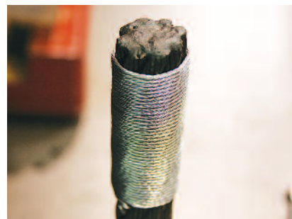
Si les pinces de serrage ont été endommagées ou trop volumineuses pour l'installation, vous devez les remplacer toutes les 3 avec une saisie de fil.
