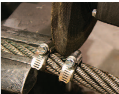
Après avoir fixé 3 colliers de serrage de chaque côté de la marque de coupe, la lame coupe la corde.
