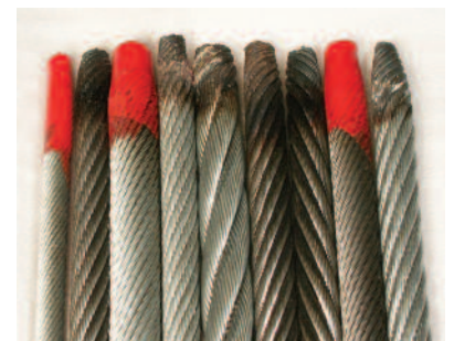
En comparaison, ce sont des extrémités fondues en usine et coniques réalisées avec une machine spécialisée.
