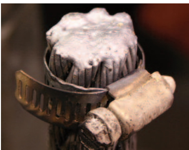
Filet de fil métallique bien fondu. Si elles ne sont pas endommagées au cours de la procédure de fusion, les pinces doivent être fixées à la corde.
