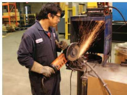
Ne pas utiliser une meule mais une lame de coupe en acier ; Par exemple : Elastique # 80EHT230-2.
